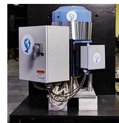
40-kW-Generator mit einem COP von 4:1
