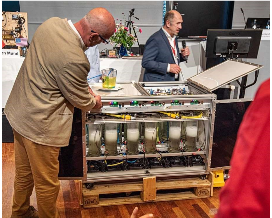
HHO-Gerät mit 12 Zellen. Die Stromaufnahme aller Zellen beträgt 4 A bei 220 V. Das entspricht einer Leistung von knapp 0,9 kW.
