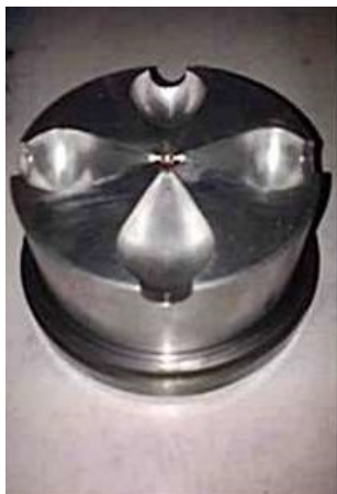
Implosions-Zylinderkopf. Die Energie wird in einer zentralen Wolfram-Hartmetallkugel konzentriert.
