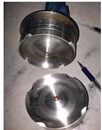
Implosions-Kolben mit Ringen, hydraulischem Dämpfer und Zylinderkopf, konzipiert für den Plasma-Injektor.
